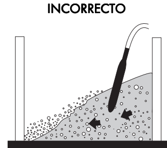
FIG. 34: El vibrador no se debe usar para transportar y distribuir el hormigón (no debe arrastrarse dentro de él), esto causa segregaciones. Tampoco se debe permitir su funcionamiento fuera del hormigón por un período prolongado de tiempo.
